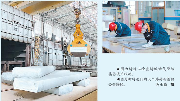
▲图为铸造工检查铸锭油气滑结晶器使用状况。
